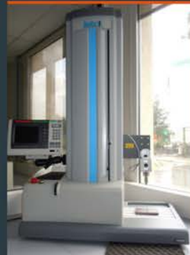
Test de résistance à la flexion
